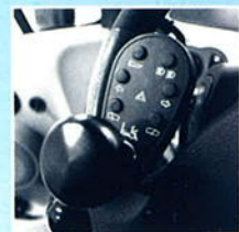
Centralisation des commandes au volant avec boule
